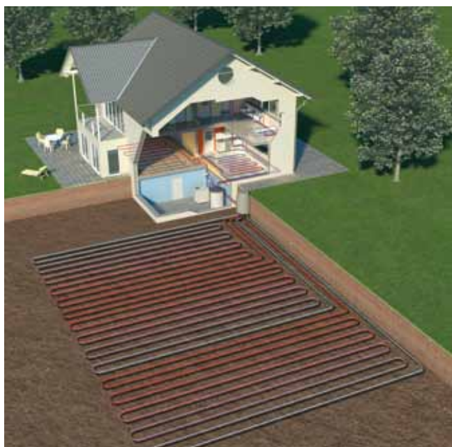
Aardwarmtegebruik met aardregister Exploitation géothermique par capteur enregisteré
