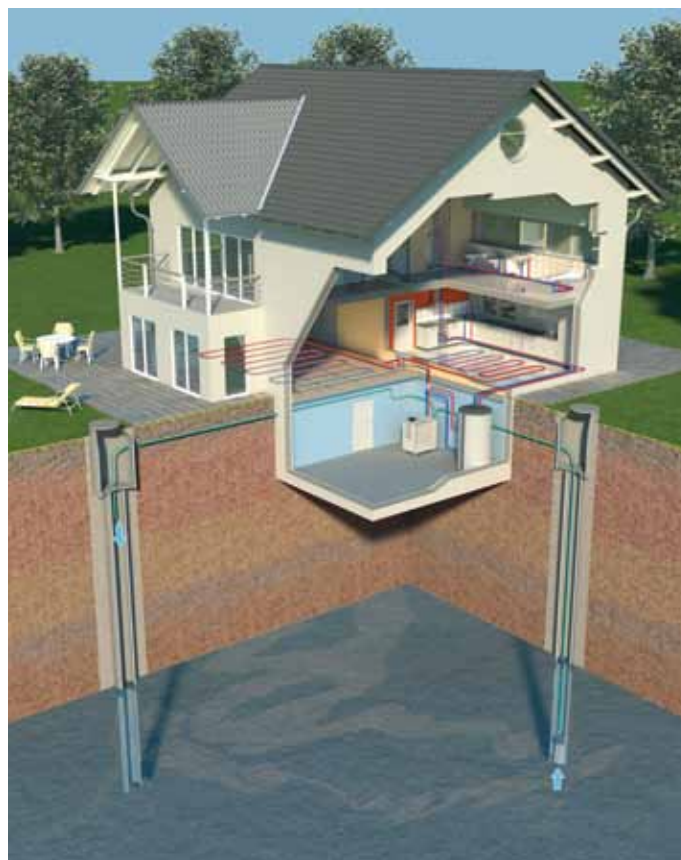
Recuperatie van de energie van grondwater Récupération d'énergie de l'eau de nappe phréatique
