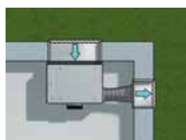
Opstellingsvarianten met aanzuig- en uitblaaszijde vrij te kiezen
